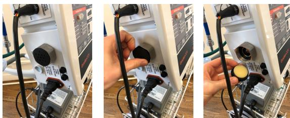
Pour remplacer le filtre, retirez l'écran de protection en le soulevant avec les ongles ou un outil plat non aiguisé. Jetez le filtre, insérez un nouveau filtre et remettez l'écran protecteur en place.
