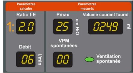
**I:E Ratio (ratio I:E) :** le ratio entre le temps d'inspiration et le temps d'expiration. Le ratio est toujours exprimé sous forme 1:Y, où Y est la valeur d'expiration. Ainsi, lorsque la valeur affichée est 2.0, le ratio I:E est 1:2 et le temps d'expiration est deux fois plus long que le temps d'inspiration. Le ratio est déterminé par le choix du clinicien en matière de temps d'inspiration et de fréquence respiratoire.
