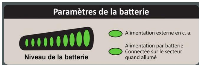
L'indicateur **Battery Level** (niveau de la batterie) fournit une estimation de la quantité d'énergie restante dans la batterie actuellement utilisée par le CCV. Lorsque l'indicateur atteint les deux barres les plus à gauche, elles deviennent rouges et une batterie différente doit être utilisée ou le CCV doit être rechargé.
