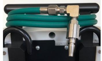
**ATTENTION :** vérifier qu'il n'y a pas de fuites visibles après le raccordement à la source d'air médical ou d'O<sub>2</sub> de 3.4 bars (344 kPa) (50 psi).
