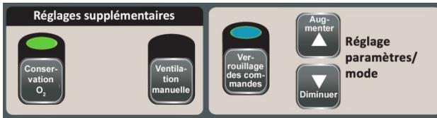
**O<sub>2</sub> Conserve** (conservation de l'O<sub>2</sub>) est utilisé lorsqu'un concentrateur d'oxygène sert de source d'oxygène ou lorsque l'utilisateur souhaite conserver l'oxygène restant dans une bouteille presque épuisée. Cette fonction limite la quantité d'oxygène utilisée pendant l'inspiration (par le connecteur du tuyau ou par le connecteur cannelé) à 10 l/min. Voir **UTILISATION DU CCV AVEC UN CONCENTRATEUR OU UN DÉBITMÈTRE** pour plus d'informations.
