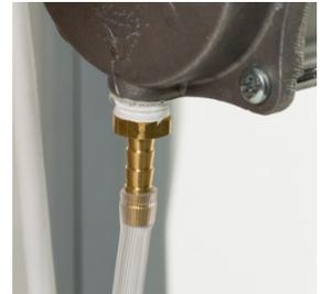
**REMARQUE :** pour utiliser la connexion cannelée du réservoir, le tuyau d'oxygène fourni doit être connecté entre la sortie du réservoir et le port DISS du CCV. Voir **UTILISATION DU CCV AVEC UN CONCENTRATEUR OU UN DÉBITMÈTRE** pour plus d'informations.
