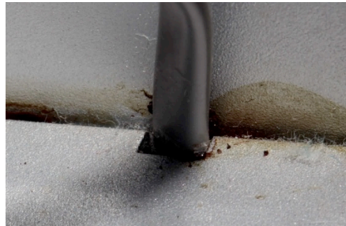
Connecteur et câble de capteur d'oxygène endommagés par des renversements d'halothane.
